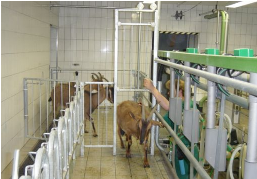
Abb. 100: Melkstand für Schafe und Ziegen (Foto Barth)
